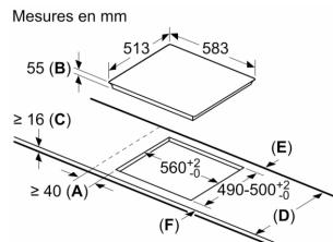
A: Distance minimum entre la découpe de la plaque de cuisson et le mur.
